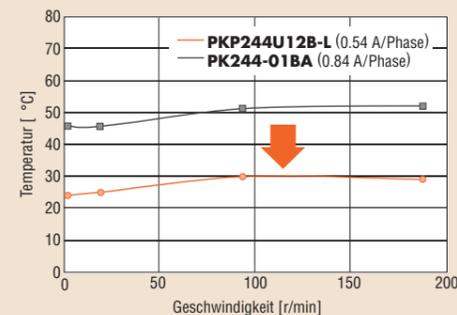
**Leistungsaufnahme zu 30% reduziert (bei geringer Geschwindigkeit)**
