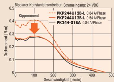
**Weniger Stromverbrauch und Wärmeentwicklung im Vergleich zum Standard-Typ PK-Serie bei gleichem Drehmoment und bei reduziertem Motorstrom des PKP-Motors.**
