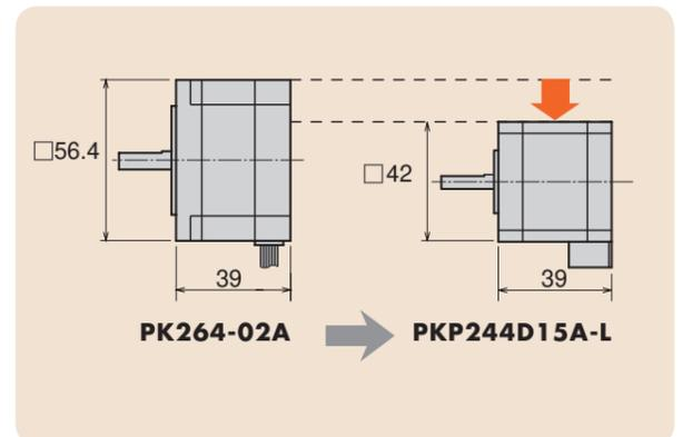
**Gleiches Drehmoment wie bei nächst größerer Baugröße!**
